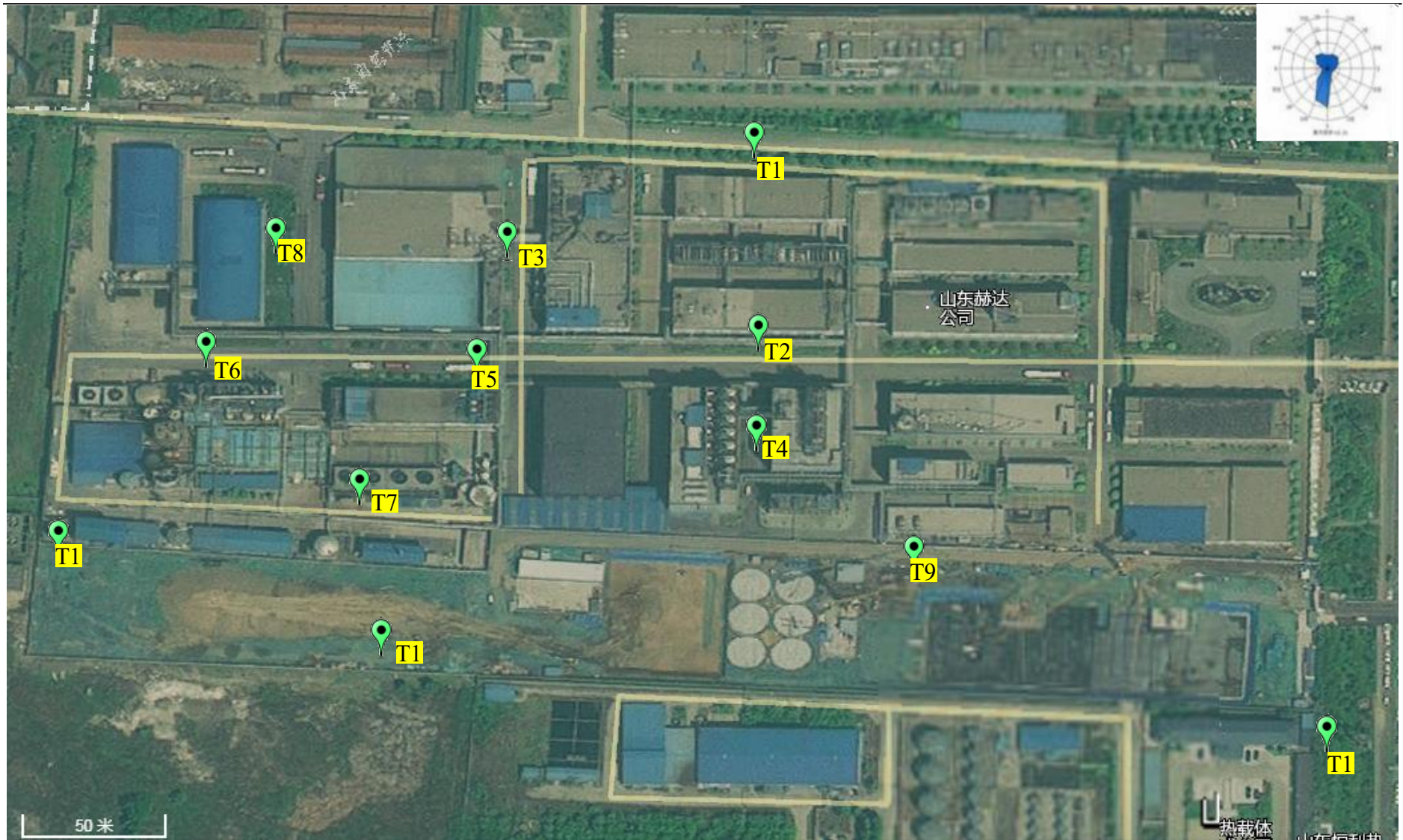
图5.2-1.1山东赫达集团股份有限公司纤维素醚事业部土壤监测点位布设示意图
